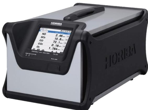
Le PG 350 de HORIBA est analyseur multi gaz portable certifié TÜV QAL I. Il permet une mesure rapide et précise, en simultanée, du CO<sub>2</sub>, du CO, de l'O<sub>2</sub>, du SO<sub>2</sub>, ainsi du NO ou des NO<sub>x</sub>, en utilisant les principes de la chimiluminescence, du paramagnétisme et du rayonnement infrarouge.
